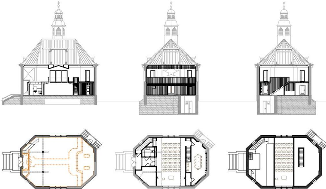
Grundriss vorher – Grundriss nach Umbau im Erdgeschoss – Grundriss nach Umbau Empore
